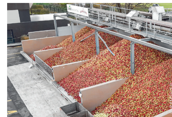
Das Mostobst wird laufend angeliefert, kurzgelagert, gewaschen und den Pressen zugeführt. Der Automatisierungsgrad der Anlage beträgt ca. 80%.
